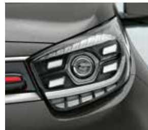
Halogen-Projektionsscheinwerfer mit Bi-Funktion (für Fernlicht) und LED-Tagfahrlicht (Silber, Gold, GT-line & X-line)
