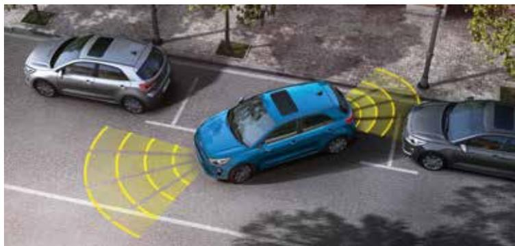
**Parksensoren, vorne und hinten mit einer Ein-/Ausschalttaste.** Ideal für sicheres Einparken. Durch Ultraschallsensoren an den vorderen und hinteren Stoßfängern wirst du beim Manövrieren auf einen Parkplatz vor Hindernissen gewarnt. Die akustischen Signale können ein- oder ausgeschaltet werden.
