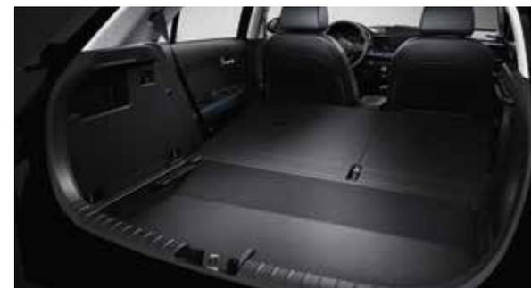
**Zweistufiger Gepäckraumboden.** Der Boden des Gepäckraums kann erhöht werden, sodass er mit den umgeklappten Sitzlehnen bündig ist (2), oder er wird abgesenkt, um hohe Gegenstände zu verstauen (3).
