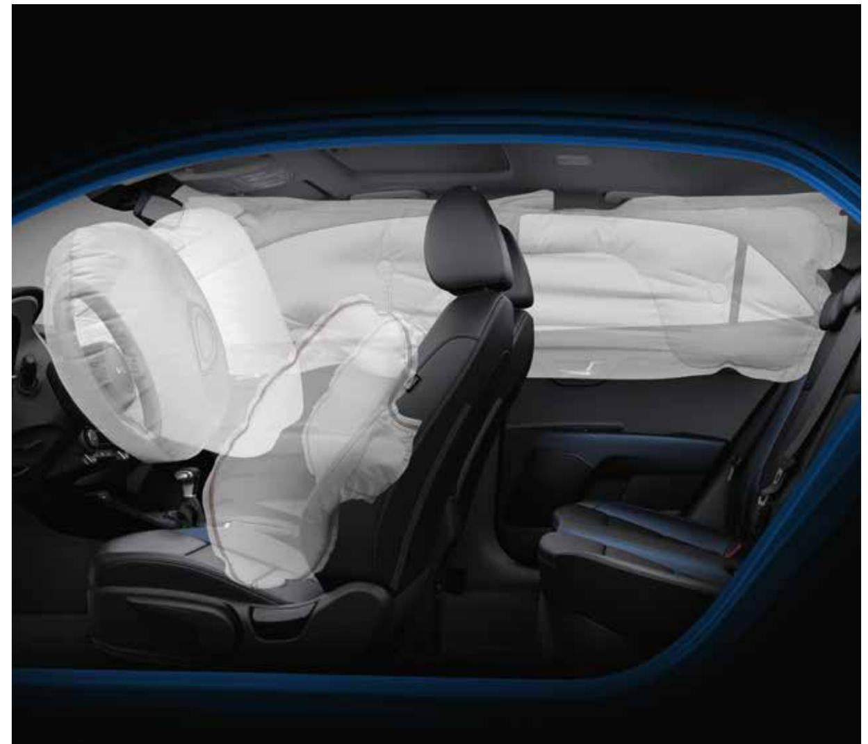
**Sechs Airbags.** Zu den Schutzfunktionen gehören auch die Front-Airbags für Fahrer und Beifahrer, zwei Airbags an den Seiten sowie zwei Vorhang-Airbags entlang der Fahrgastzelle.
