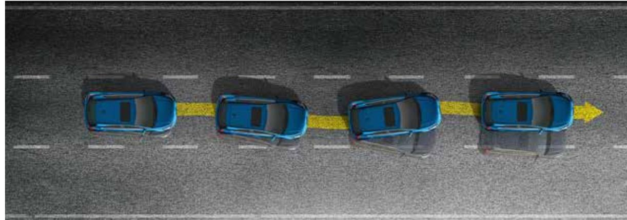
**Spurgenauigkeit.** Beim Bremsen auf einer geraden Strecke erkennt das System den Unterschied der Anwendung des Bremsdrucks zwischen den rechten und linken Rädern und passt den Druck an, um die geradlinige Stabilität beim Fahren beizubehalten.
