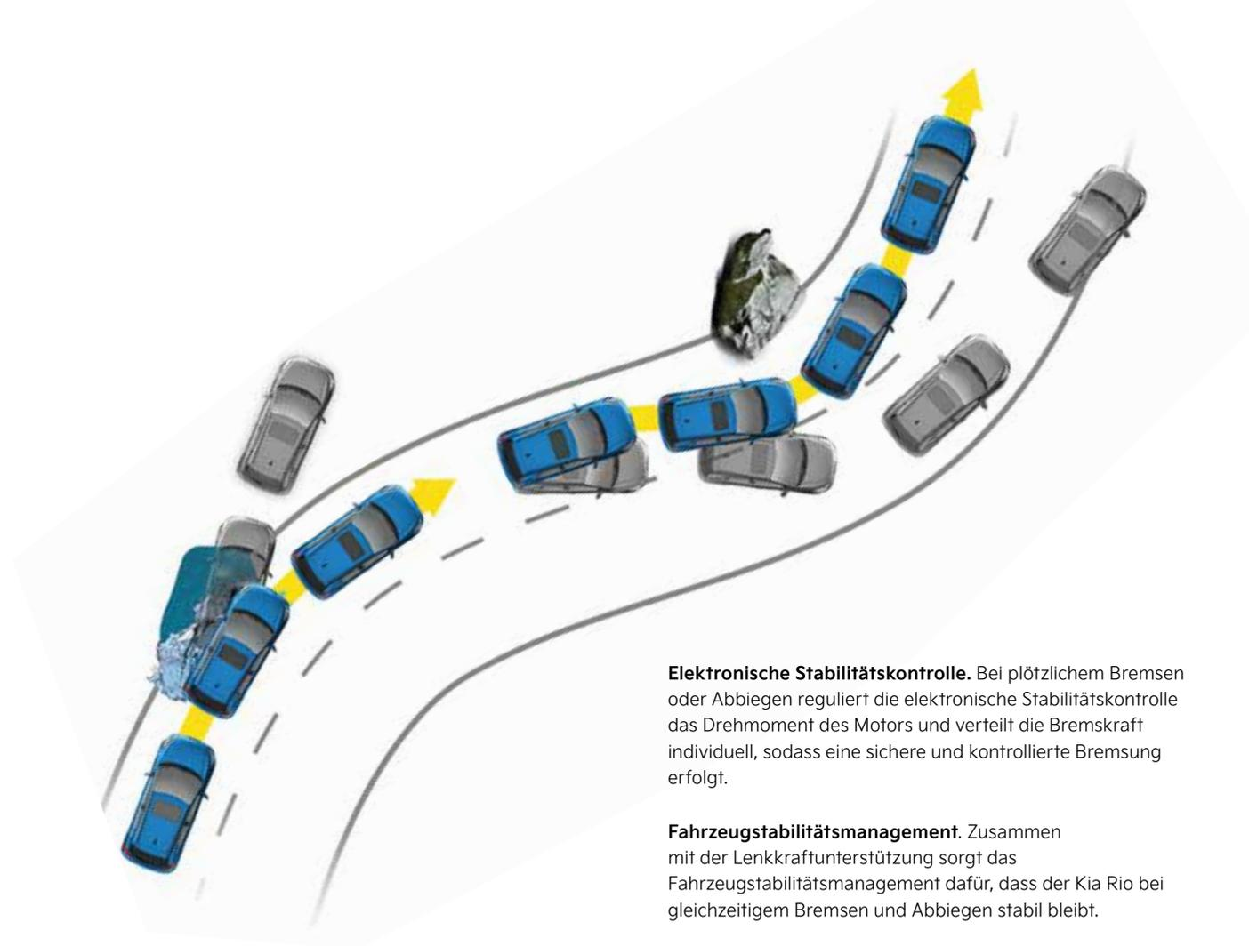
**Elektronische Stabilitätskontrolle.** Bei plötzlichem Bremsen oder Abbiegen reguliert die elektronische Stabilitätskontrolle das Drehmoment des Motors und verteilt die Bremskraft individuell, sodass eine sichere und kontrollierte Bremsung erfolgt.
