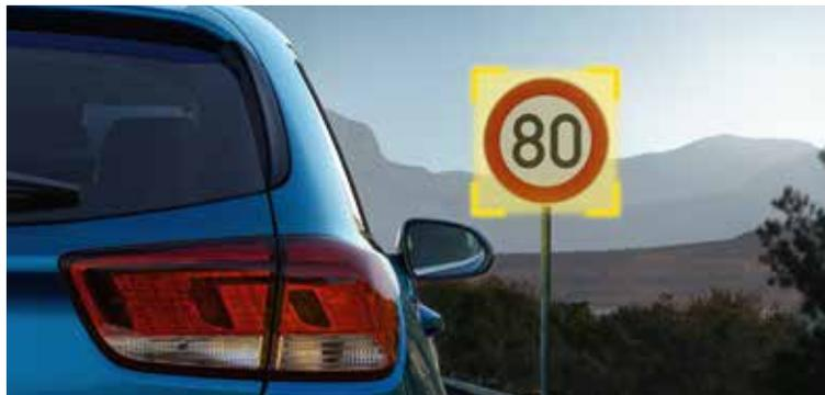
**Intelligentes Tempolimitinformationssystem.** Mithilfe einer Kamera informiert das Tempolimitinformationssystem stets über geltende Geschwindigkeitsbegrenzungen und zeigt Geschwindigkeitstafeln und Überholverbotstafeln an. Diese Informationen werden übersichtlich am Navigationsbildschirm und am Supervision Cluster angezeigt.
