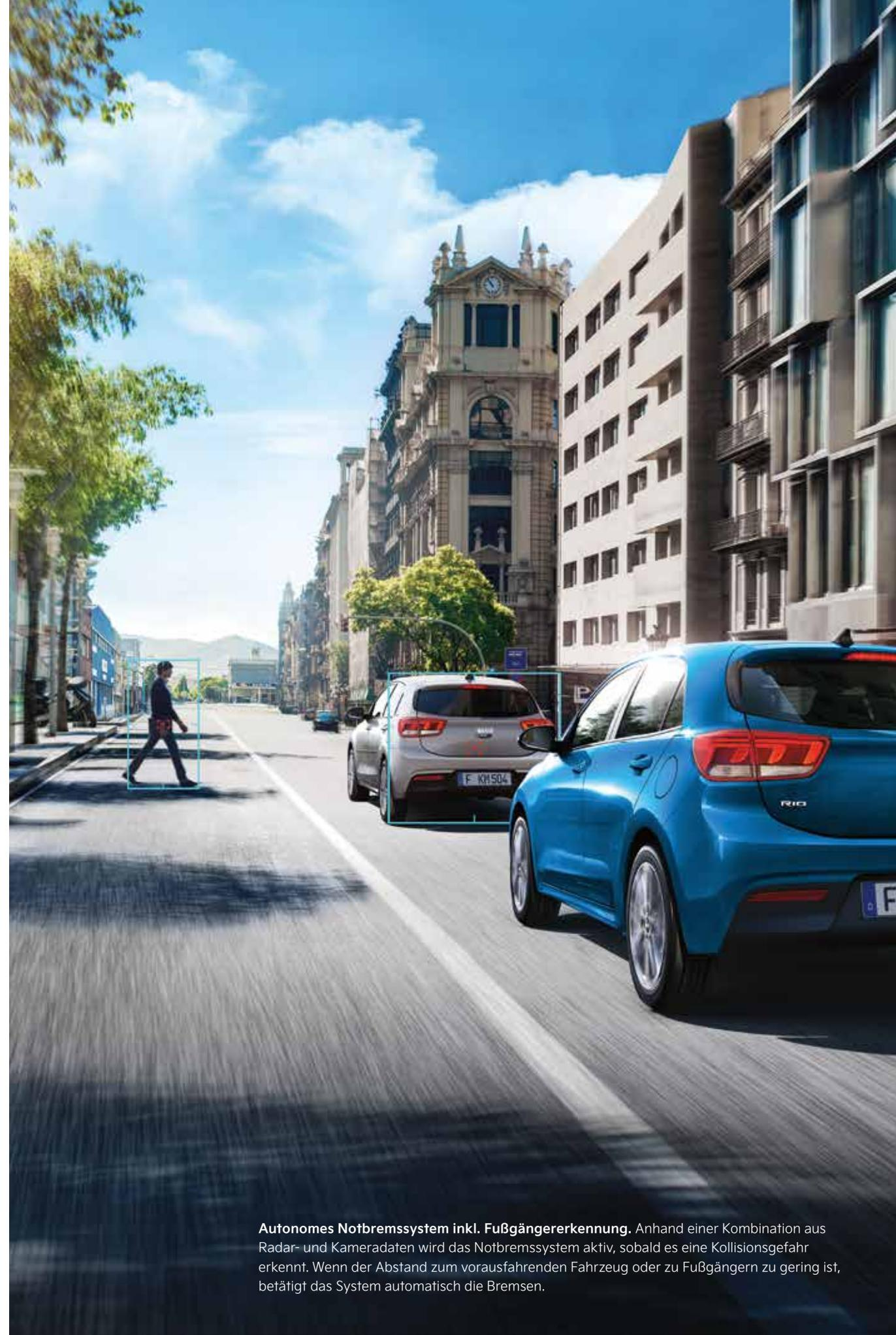
**Autonomes Notbremssystem inkl. Fußgängererkennung.** Anhand einer Kombination aus Radar- und Kameradaten wird das Notbremssystem aktiv, sobald es eine Kollisionsgefahr erkennt. Wenn der Abstand zum vorausfahrenden Fahrzeug oder zu Fußgängern zu gering ist, betätigt das System automatisch die Bremsen.
