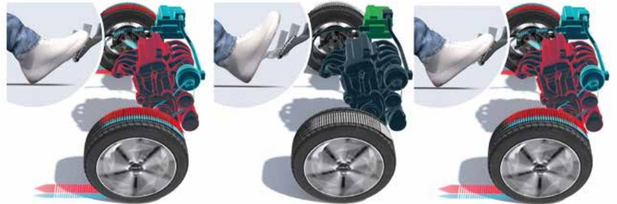
**Ausrollmodus.** Wenn der Fahrer den Fuß vom Gas nimmt und das Auto ohne Beschleunigung im Leerlauf laufen lässt, schaltet sich der Motor reibungslos ab, was zu einer effizienteren Fahrt führt. Sobald das Gaspedal gedrückt wird, übernimmt sofort der Motor. Die Ausrollfunktion und die bei ausgeschaltetem Motor zurückgelegte Strecke hängen von den Fahrbedingungen und der Fahrzeuggeschwindigkeit ab.
