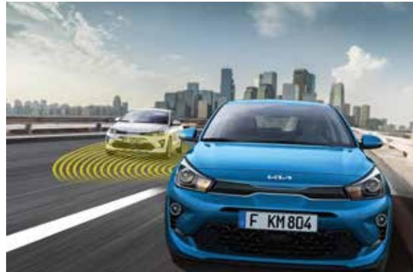
**Totwinkelassistent.** Er überwacht mittels Radarsensoren, die Zone, welche in deinem toten Winkel liegt. Das Sicherheitssystem warnt anhand eines Symbols und eines Blinklichts im Außenspiegel vor sich nähernden Fahrzeugen.
