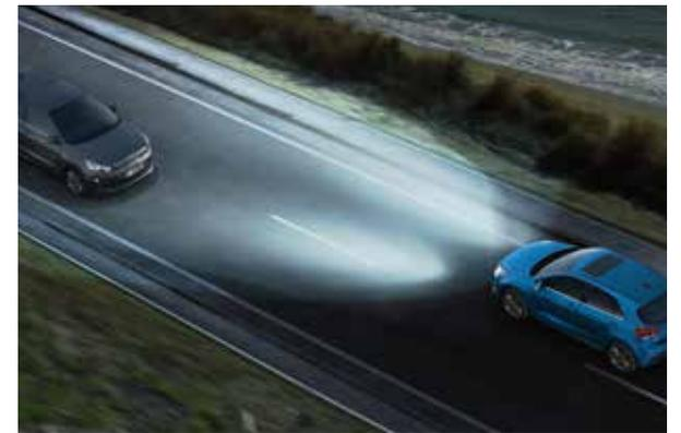
**Fernlichtassistent.** Erkennt die Kamera an der Windschutzscheibe die Scheinwerfer eines entgegenkommenden Fahrzeugs bei Dunkelheit, schaltet der Fernlichtassistent automatisch auf Abblendlicht. Sobald das Fahrzeug vorbeigefahren ist, schaltet sich das Fernlicht wieder ein.
