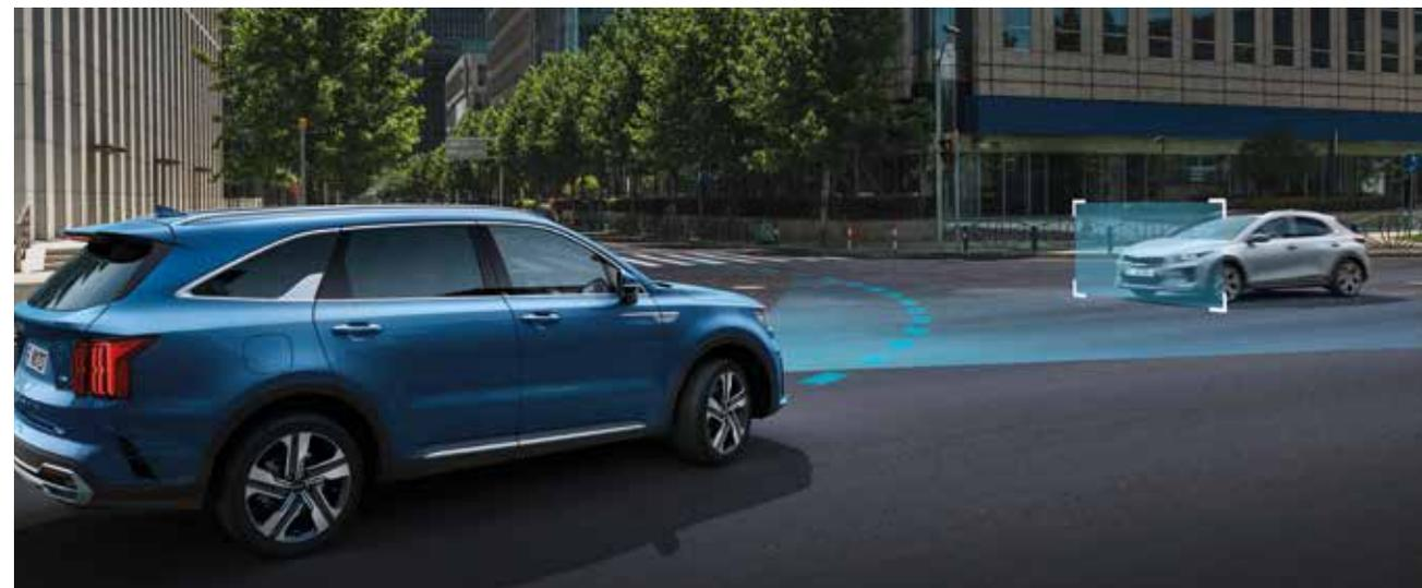
**Autonomer Notbremsassistent inkl. Linksabbiegeassistent.** Der autonome Notbremsassistent wertet sowohl Kamera- als auch Radardaten deines Fahrzeugs aus und analysiert Informationen über nahende Autos, Fußgänger oder Radfahrer, um eine mögliche Kollision zu vermeiden. Weiters werden auch Kollisionen mit Fahrzeugen verhindert, wenn du an einer Kreuzung links abbiegen möchtest. Wenn eine mögliche Kollision erkannt wird, wirst du mit einem Signal gewarnt und die Bremse wird automatisch getätigt.
