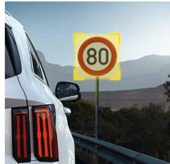
**Intelligentes Tempolimitinformationssystem.** Mithilfe einer Kamera informiert das Tempolimitinformationssystem stets über geltende Geschwindigkeitsbegrenzungen und zeigt Geschwindigkeitstafeln und Überholverbotstafeln an. Diese Informationen werden übersichtlich am Navigationsbildschirm und am Supervision Cluster angezeigt.
