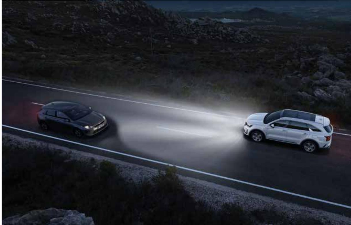
**Fernlichtassistent.** Der Fernlichtassistent erkennt durch eine Kamera in der Windschutzscheibe vorausfahrende Fahrzeuge und wechselt automatisch zwischen Fern- und Abblendlicht, um sich den Fahrbedingungen anzupassen.
