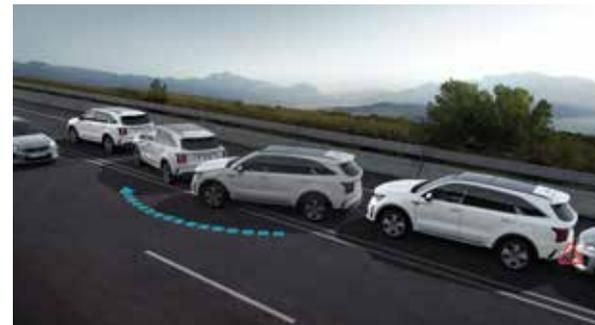
**Multikollisionsbremse.** Wird dein Airbag als Reaktion bei einer Kollision ausgelöst, wird sofort ein Signal an das elektronische Stabilitätskontrollsystem gesendet, um dein Fahrzeug automatisch zu bremsen, um eine nachfolgende Kollision zu verhindern oder deren Auswirkungen zu mildern.
