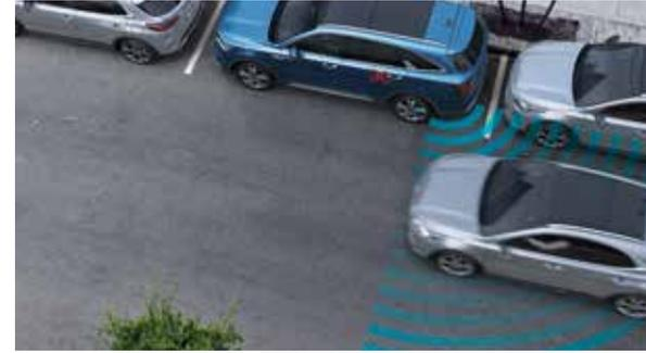
**Ausstiegsassistent.** Der Ausstiegsassistent erkennt potenzielle Gefahren, die sich dem Fahrzeug nähern und warnt Passagiere vor dem Aussteigen. Im Notfall verriegelt das System automatisch die hinteren Türen und gibt ein akustisches und visuelles Signal ab, um ein Aussteigen zu verhindern.
