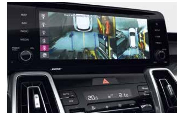
**360° around view Monitor.** Umgeben von Sicherheit: Dieses intuitive System kombiniert vier Weitwinkel-Bilder von Kameras, welche sich vorne, hinten und an den Seiten des Fahrzeugs befinden, um dir einen umfassenden Überblick über die Umgebung des Kia Sorento in Vogelperspektive zu bieten, während du einparkst, oder dich mit einer Geschwindigkeit von weniger als 20 km/h bewegst.
