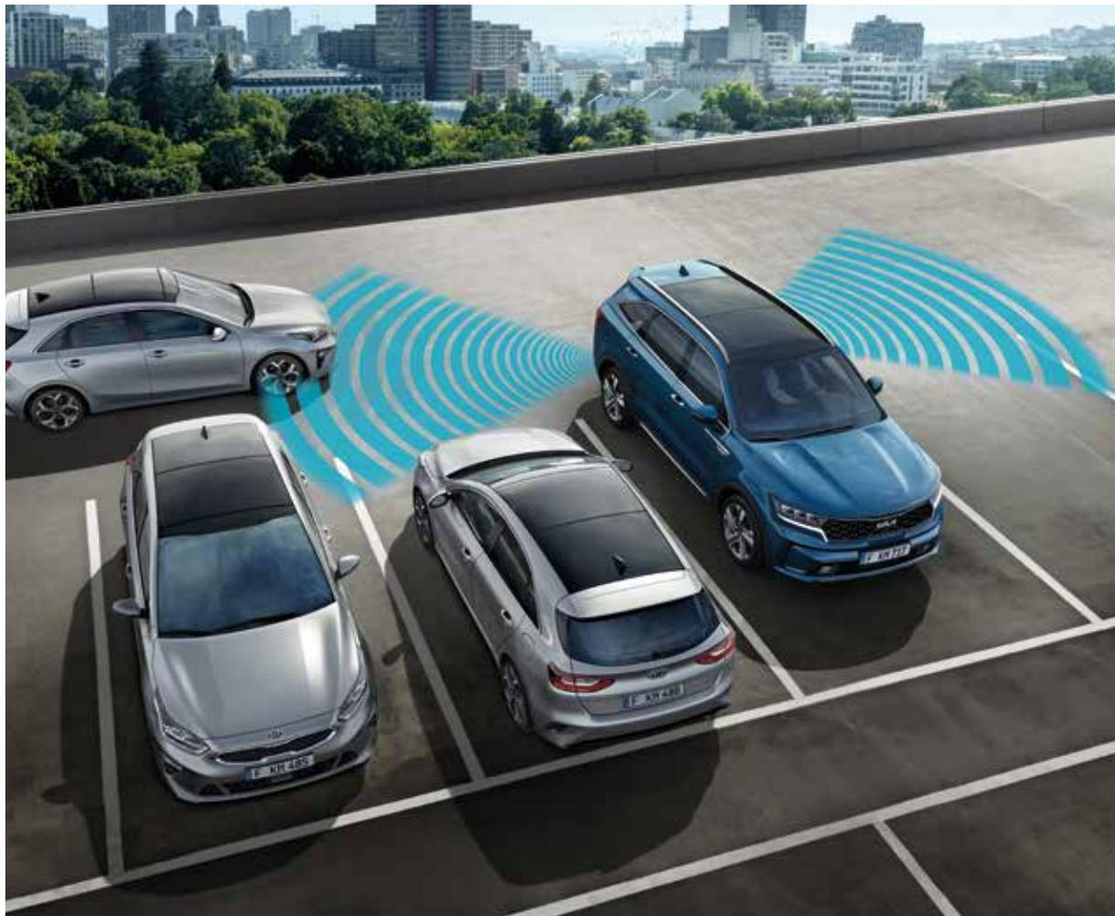
**Querverkehrsassistent.** Sicher rückwärts ausparken - beim Ausparken aus Längsparklücken warnt das radarbasierte System vor potentiellem Verkehr, welcher deinen Weg kreuzt. Sobald eine Gefahr erkannt wird, warnen audiovisuelle Hinweise davor und im Notfall bremst das Fahrzeug automatisch. (Das System kann über das Menü teilweise deaktiviert werden, um das automatische Bremsen zu verhindern)
