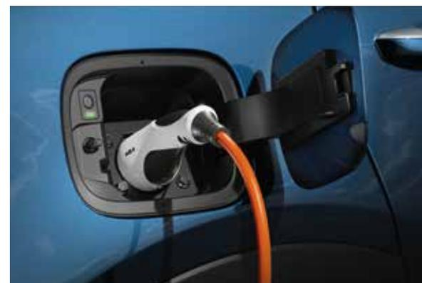
**Ladekabel & Kontrollbox.** Der Kia Sorento Plug-In Hybrid wird mit einem maßgeschneiderten Ladekabel zum Aufladen zu Hause bei einer normalen Haushaltssteckdose sowie einer Kabelbox geliefert, um die Stromstärke zu verringern und die vollständige Sicherheit zu gewährleisten.
