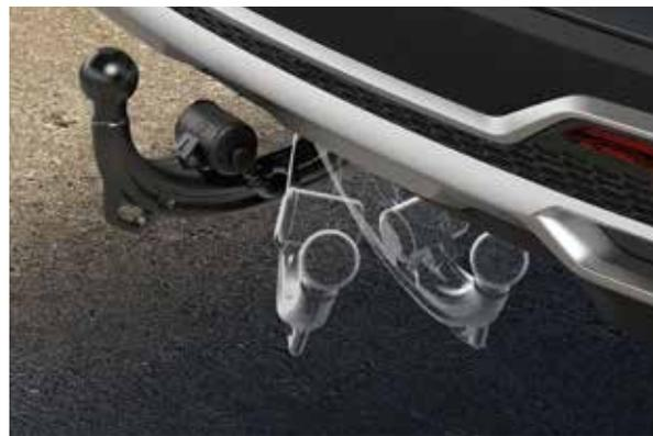
**Einklappbare Anhängerkupplung.** Nur für Dieselmodelle: Bequemes Einsetzen und Einfahren der vollelektrischen Anhängerkupplung mittels Schalter im Kofferraum.
