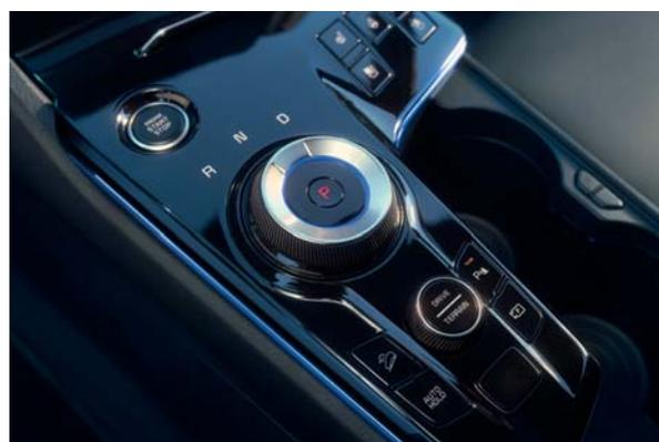
**Drehbarer Schaltknopf.** Der zentral und griffgünstig platzierte Drehschalter arbeitet mit der Shift-by-Wire-Technologie und ermöglicht so müheloses Schalten. Ebenso wichtig für die Sicherheit: Er schaltet automatisch in den Parkgang P, wenn der Fahrer dies vergisst.
