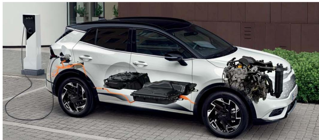
**Intelligente Fahrtechnologie.** Mit einem Knopfdruck auf die Hybrid/Elektro-Taste (HEV/EV) in der Mittelkonsole kannst du zwischen Elektro- und Hybridbetrieb wählen. Im EV-Modus - ideal für den Stadtverkehr - nutzt der Sportage Plug-in-Hybrid vorrangig rein elektrische Energie für emissionsfreies Fahren\*. Im HEV-Modus werden beide Energiequellen genutzt, wobei je nach Situation entweder nur der Benzinmotor, nur der Elektromotor oder beide gleichzeitig zum Einsatz kommen.
