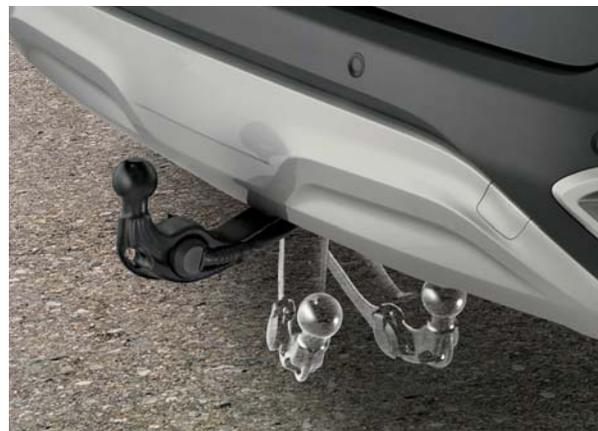
**Anhängerkupplung, einfahrbar.** Möchtest du mehr Komfort mit effizienter Transportleistung kombinieren? Mittels einem Schalter im Kofferraum kannst du diese hochqualitative, vollelektrische Anhängerkupplung bequem ein- und ausfahren. Wenn sie nicht in Gebrauch ist, befindet sie sich zusammengelegt hinter dem hinteren Stoßfänger.
