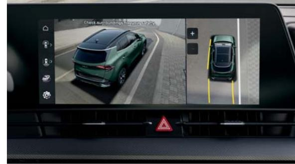
**360-Grad-Surround-View-Monitor (SVM).** Beim Manövrieren auf engem Raum bieten mehrere Kameras eine zoombare 360°-Übersicht über das Fahrzeug, sodass du sicher lenken und einparken kannst. Du musst nicht aus dem Fahrzeug aussteigen, um die Abstände zu prüfen oder andere um Hilfe zu bitten.
