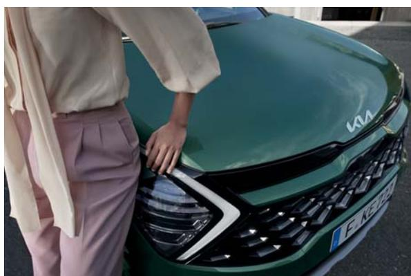
**Intelligentes Frontbeleuchtungssystem.** Ein klarer und deutlicher Unterschied in der Fahrsichttechnologie. Wenn die Matrix-LED-Scheinwerfer auf Fernlicht eingestellt sind und das intelligente Frontbeleuchtungssystem ein anderes Fahrzeug erkennt, das entweder in dieselbe oder in die entgegengesetzte Richtung fährt, schaltet es die LEDs automatisch auf Abblendlicht um, damit der andere Fahrer nicht geblendet wird. Wenn die Straße wieder frei ist, schaltet es automatisch wieder zurück.
