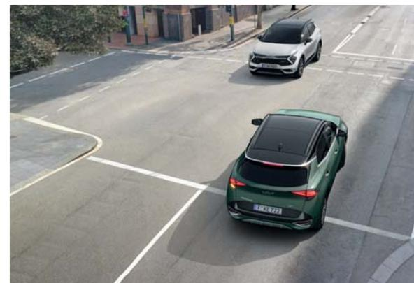
**Kollisionsverhinderungs-Assistent (FCA).** Das FCA-System wertet sowohl Kamera- als auch Radardaten deines Fahrzeugs aus und analysiert Informationen über andere Autos, Fußgänger oder Radfahrer, die die Straße überqueren, um eine mögliche Kollision zu vermeiden. FCA verhindert auch Kollisionen mit Fahrzeugen, die an einer Kreuzung nach links abbiegen. Wenn es eine mögliche Kollision erkennt, erscheint ein Warnsignal auf im Kombiinstrument und die maximale Bremsleistung wird aktiviert.
